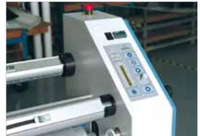
Außen angeordnete Bremsen zur besseren Einstellung der Folienspannung an den Materialaufnahmen.
